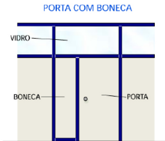
Figura 05: Instalação de porta
