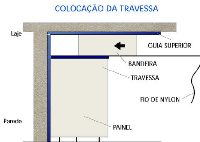
Figura 04: Sentido de montagem da guia superior
